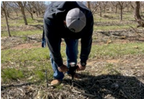
Figura 4. Penetrómetro marca 200 psi a 63 cm de profundidad. Un suelo con baja compactación y lleno de poros, esto ayuda a filtrar el agua y retener más humedad.
