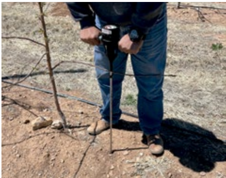
Figura 3. Penetrómetro marca los 200 psi a los 17 cm de suelo, notoria compactación de suelo.
