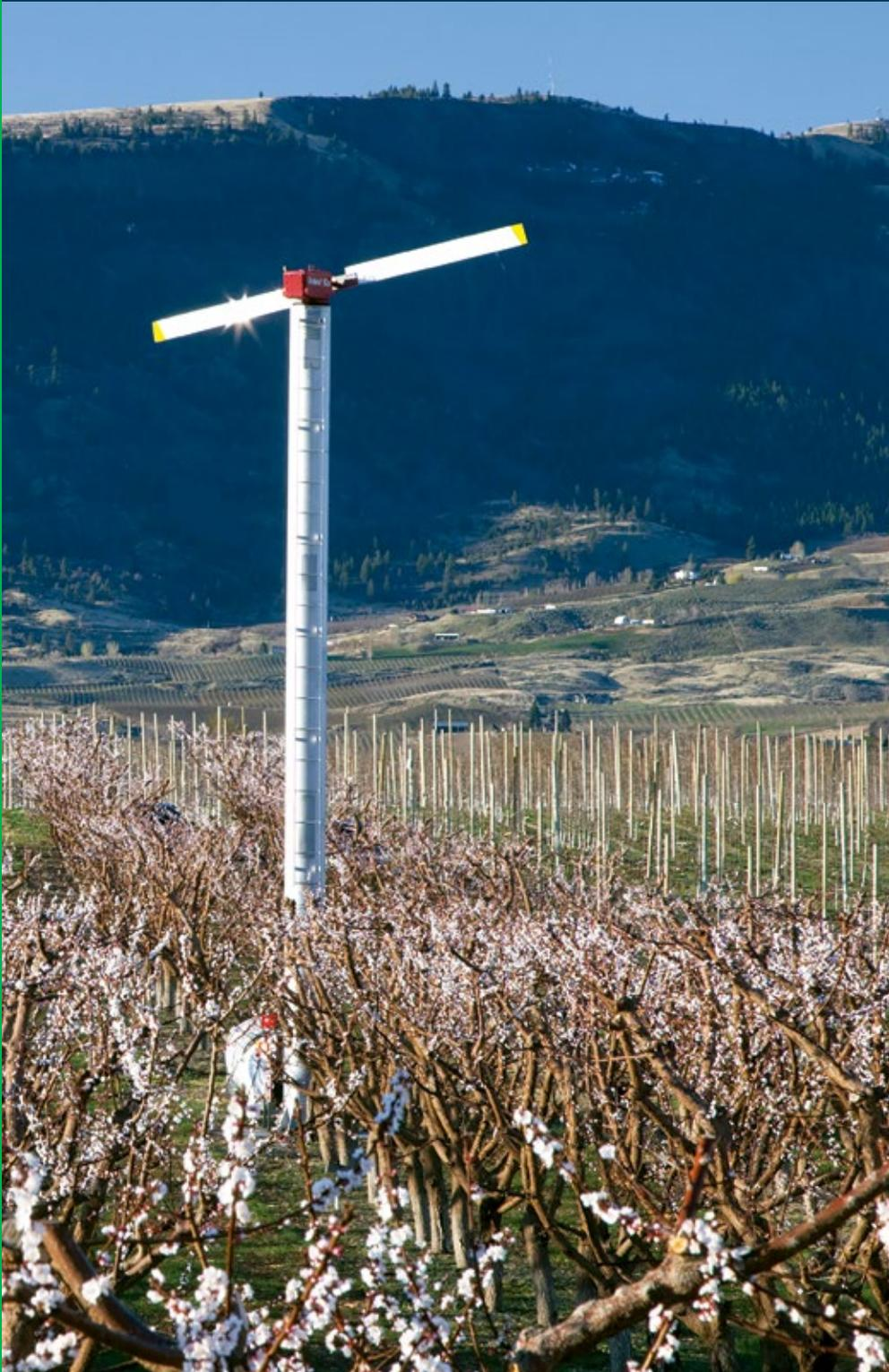
Las máquinas de viento de Orchard-Rite pueden equiparse con tecnología de vigilancia de ORCell. Esto le permite prender y apagar sus máquinas de viento de forma remota, Reaccione rápidamente sin tener que estar en el campo físicamente, proporciona protección automatizada contra la helada.
